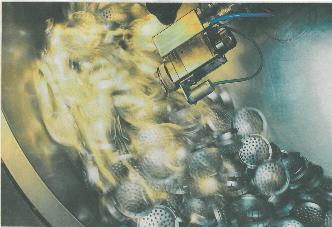
Schnell und präzise: Eine Automatik-Sprühpistole beschichtet bei Infrarotlicht die in der Trommel befindlichen Teile.
